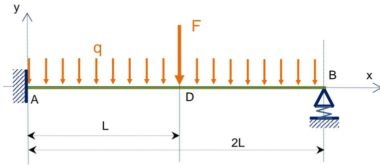
De façon classique, on peut prendre la poutre encastree en A comme système isostatique associé avec la condition en déplacement au point B correspondant à l'allongement du câble
