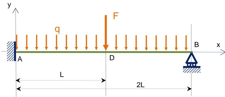
De façon classique, on peut prendre la poutre encadrée en A comme système isostatique associé avec la condition en déplacement au point B
