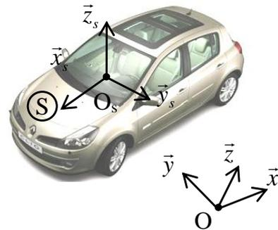
Le repère  $R_s$  étant caractérisé par son origine  $O_s$  et sa base  $(\vec{x}_s, \vec{y}_s, \vec{z}_s)$ , il faut d'abord définir la position de l'origine  $O_s$  dans R puis l'orientation de la base  $(\vec{x}_s, \vec{y}_s, \vec{z}_s)$  de  $R_s$  par rapport à la base  $(\vec{x}, \vec{y}, \vec{z})$  de R.
