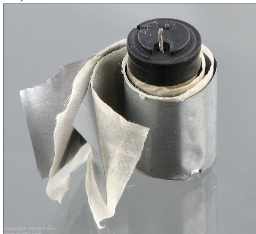
Un condensateur en forme de cylindre peut cacher un condensateur plan...
