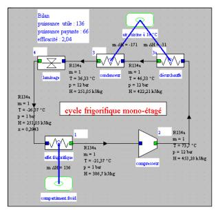
Le refroidissement du fluide dans le condenseur par échange avec l'air extérieur comporte deux étapes : une désurchauffe dans la zone vapeur suivie d'une condensation, avec un sous-refroidissement de 10 °C.
