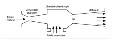
Le fluide moteur est accéléré dans un convergent-divergent, créant une baisse de pression dans la zone de mélange, ce qui a pour effet d'aspirer le fluide secondaire. Les deux fluides sont alors mélangés et une onde de choc peut prendre place au niveau du col. Il en résulte une augmentation de la pression du mélange et une baisse de sa vitesse, qui devient subsonique. Le diffuseur permet de convertir la vitesse résiduelle en augmentation de pression.
