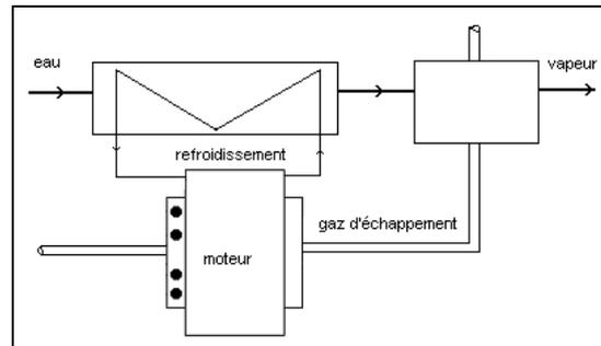
Le modèle Thermoptim reprend celui que nous avons présenté lors de l'étude des moteurs alternatifs à combustion interne, en le complétant par deux échangeurs de cogénération.
