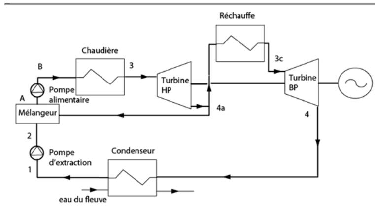
Considérons un cycle avec une resurchauffe. Si l'on prélève un peu de vapeur en sortie de la première détente, au point **4a** sur la figure, sa pression reste suffisante pour qu'on puisse la condenser à une température assez élevée pour préchauffer l'eau sous pression sortant de la pompe au point **2**.
