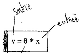
La sortie  $v(t)$  est donc le résultat du produit de convolution de l'entrée  $x(t)$  par la fonction  $\theta(t)$  qui caractérise le circuit et qui dépend de la "constante de temps" RC.
