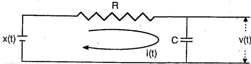
L'entrée est la tension  $x(t)$ , la sortie est  $v(t)$  tension aux bornes du condensateur.
