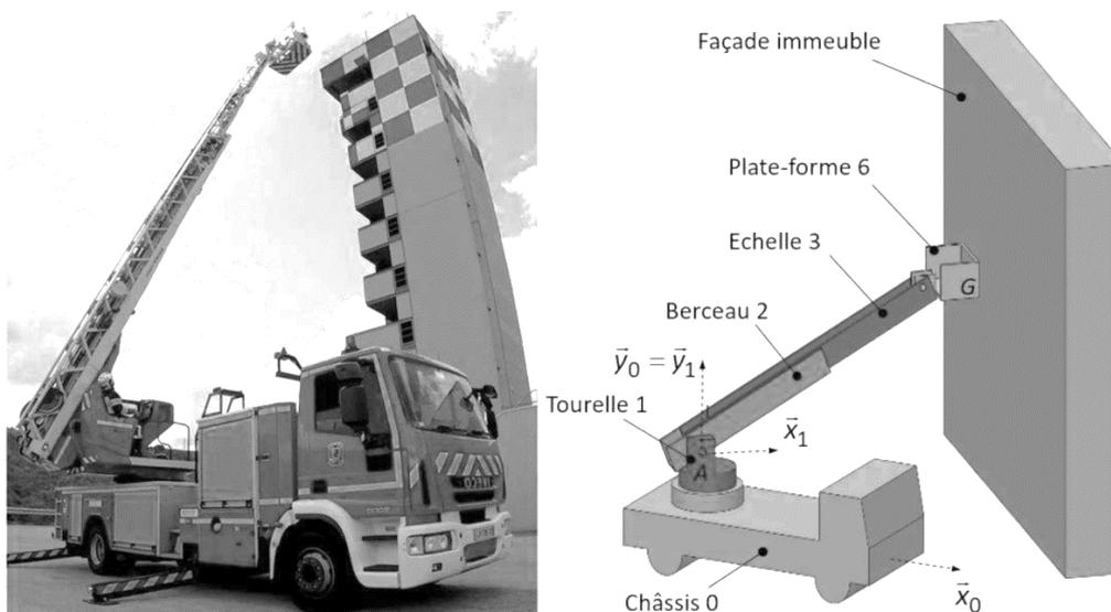
*Une E.P.A.S. est une Echelle Pivotante Automatique à commande Séquentielle.*
