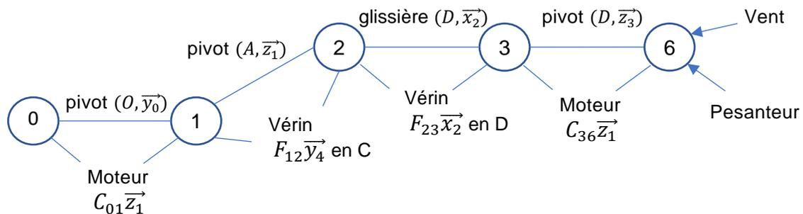
Q7. Déterminer l'expression du couple  $C_{36}$  permettant de maintenir la plateforme 6 immobile par rapport à l'échelle 3.
