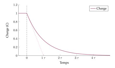
Courbe de décharge d'un condensateur de charge initiale 1 C et de constante de temps  $\tau=1$  s. Remarquez comme la tangente à l'origine passe par  $\tau$ .
