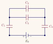
$C_2$  est en parallèle de  $C_3$ . Cela correspond à une capacité équivalente :
